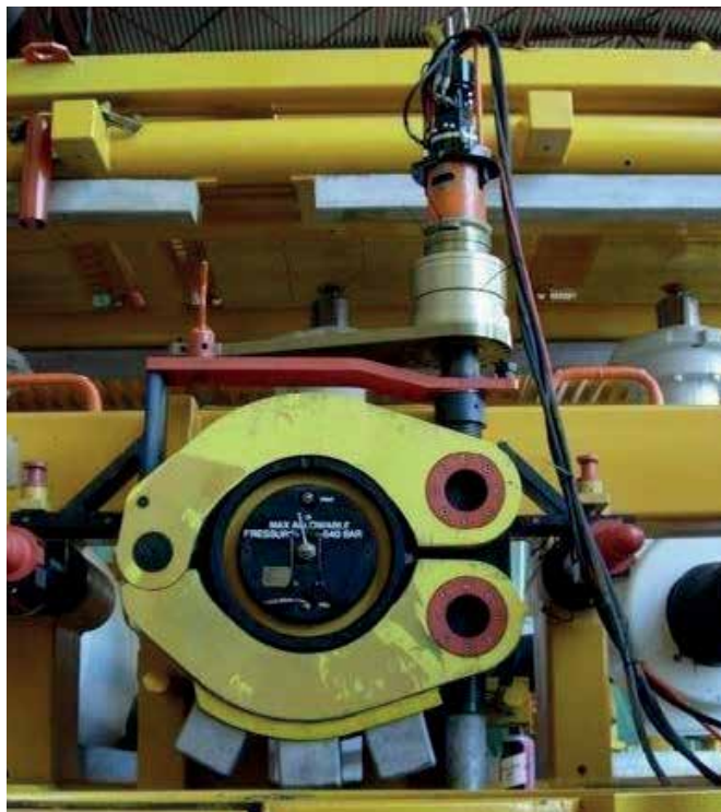
Rohrschellenwerkzeug im Test
