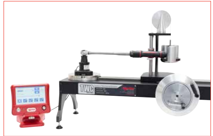
Drehmomentschlüssel-Prüfvorrichtung (TWC), manuell, mit Gegengewichts-System (62272), FMT Messwertgeber und einer T-Box XL™.
