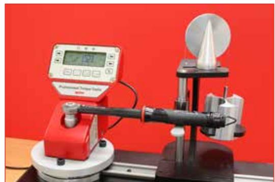
60323 Pro-Test und statischer Drehmomentblock-Adapter-Satz
